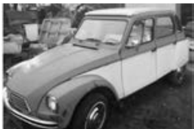
Рис. 3. Автомобиль Citroen 2CV кузов которого изготовлен из пенополиуретана.
