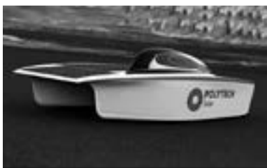
Рис. 4. Российский образец автомобиля. Кузов выполнен из композитных материалов в форме катамарана, общий вес автомобиля менее 200,0 кг. Ожидается, что скорость автомобиля будет достигать 150,0 км/час.
