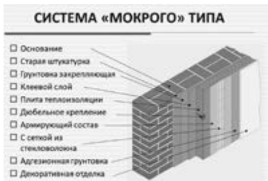
Рис.7. Система «скрепленной» теплоизоляции фасадов
