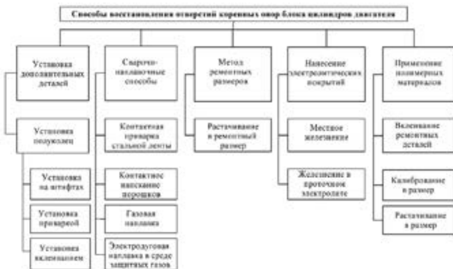
Рис. 1.1. Классификация способов восстановления опор коренных подшипников блока цилиндров
