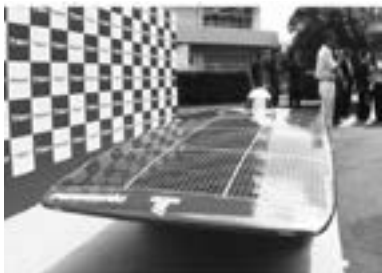
Рис. 5. Японский кар «TokaiChallenger 2», на модели установлены солнечные панели разработки компании Panasonic. Корпус выполнен из углеродистого пластика, его вес составляет 140,0 кг. Максимальная скорость – 160,0 км/час.
