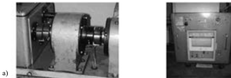
Рис. 2. Штатное оборудование для контроля момента трения машины трения СМЦ-2: а) – дифференциальный магнитный датчик, б) – шкаф управления со следящим устройством (КСУ).[4]
