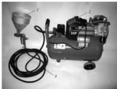
Рис. 2. Комплект мобильной установки, которые используется для набрызга мелкозернистого бетона: 1 – пистолет-распылитель; 2 – передвижной компрессор; 3 – шланг пневматический.
