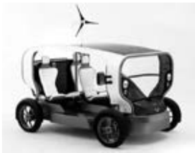
Рис. 3. Модель «Ecletic», разработки специалистов компании Venturi (Франция), оснащена силовой установкой, мощностью 22,0 л/с, запасом хода в 50,0 км и может развивать скорость 50,0 км/час.
